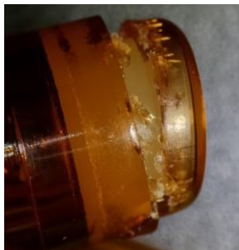
Figura 2 - Exemplu de deteriorare a portului de injectare
